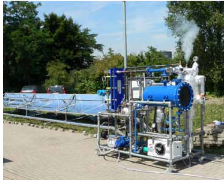
Solarthermie Kaltwasser-Generator mit Parabolrinnen-Kollektor-System und Dampfstrahlkältemaschine
